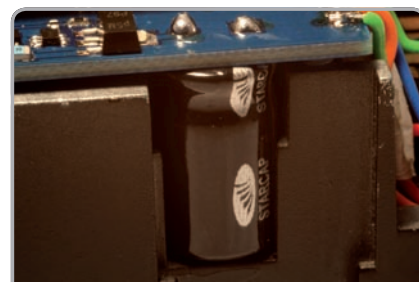
Kontaktsicher: PowerPack Energiespeicher
