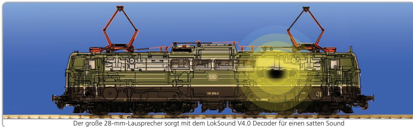
Der große 28-mm-Lausprecher sorgt mit dem LokSound V4.0 Decoder für einen satten Sound
