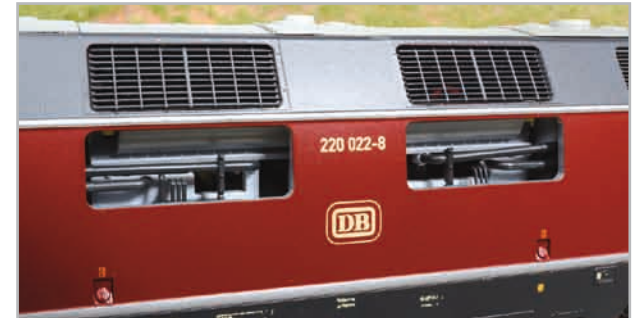
Maschinenraum (hier mit abgenommenen Fenstern)
