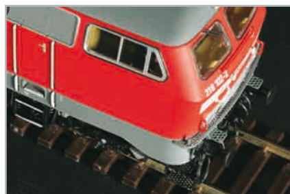
Durchbrochene Trittstufen aus Ätzteilen
