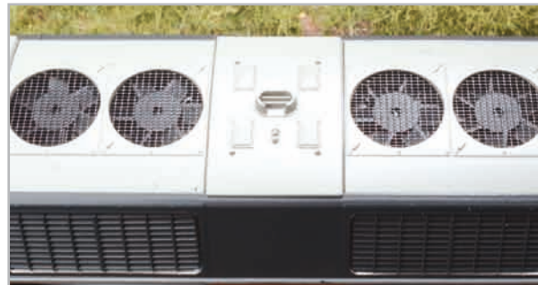
Durchbrochene Lüftergitter; separat eingesetzte Rotoren
