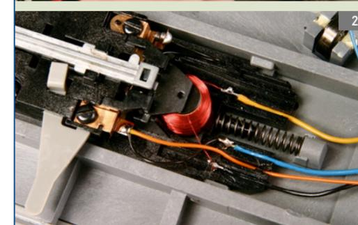
2. Die zuvor gemeinsam gelegten Verbindungen zwischen Motor und Spule werden aufgetrennt und einzeln gelegt.
