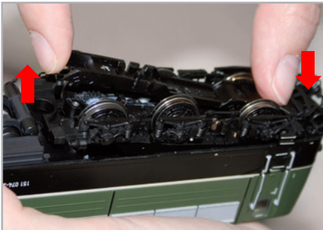
Abb. 13: Abheben der Getriebeabdeckung
