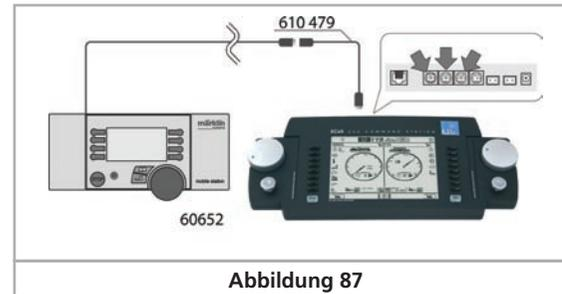
Wenn die mobile station das erste mal an die Zentrale angesteckt wird, wird die interne Softwareversion der mobile station überprüft. Sollten deren Version älter sein als die in der Zentrale gespeicherte, wird diese automatisch aktualisiert. Die mobile station wird in dieser Zeit nicht reagieren und auch kein Bild anzeigen. Dies ist normal! Auf dem Bildschirm der Zentrale erscheint ein Hinweisbildschirm zur Erinnerung.
