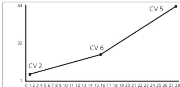
Abbildung12: Geschwindigkeitseinstellung mit CV 2, 5, 6
