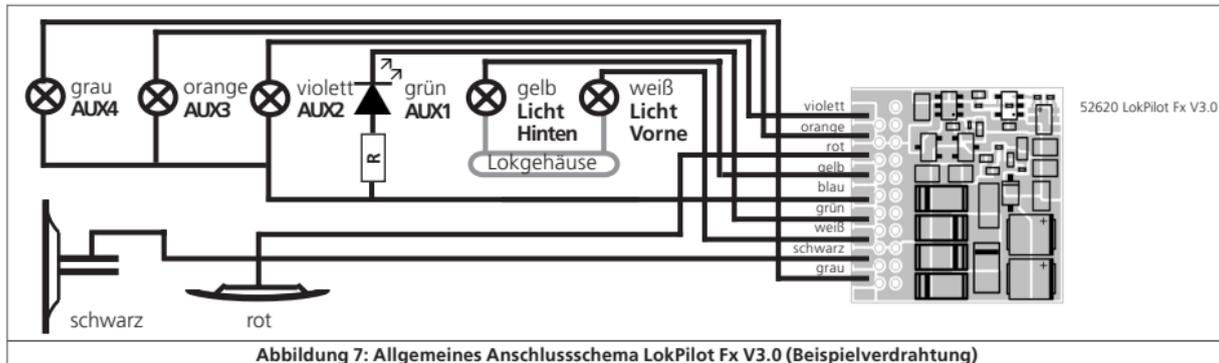
Abbildung 7: Allgemeines Anschlusschema LokPilot Fx V3.0 (Beispielverdrahtung)
