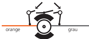
Abbildung 9: 5-poliger Märklin® Hochleistungsmotor
